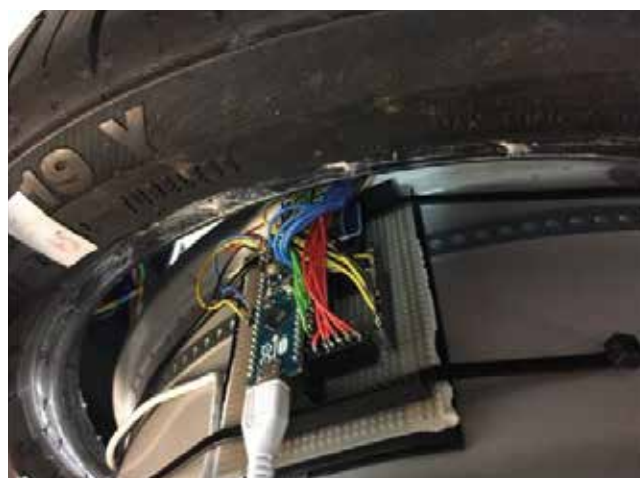
Abbildung 5.45: Messaufbau im Reifeninneren
