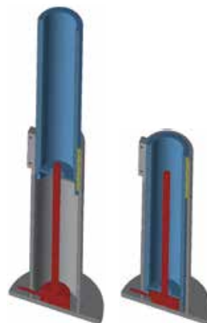
Abbildung 5.31: Astrosäule im ausgefahrenen und eingefahrenen Zustand
