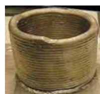
Abbildung 5.18: 3D-gedrucktes Mg-Demonstrationsbauteil (Messevorstellung MUTHO)
