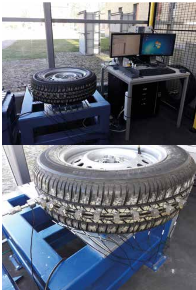
Abbildung 5.49: Modalanalyseprüfstand (oben) und triaxiale Beschleunigungssensoren (unten)
