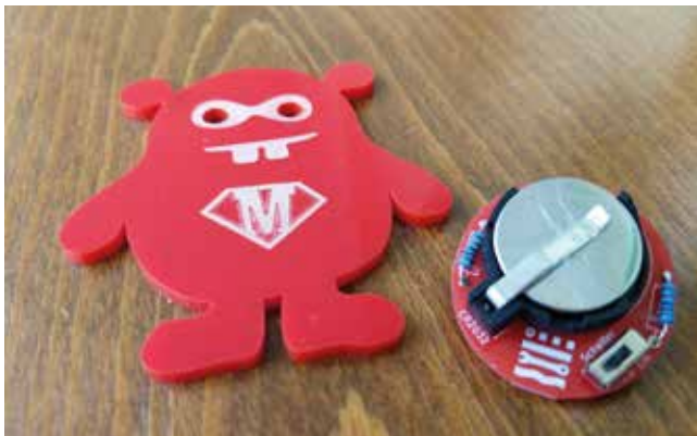
Abbildung 5.41: Das neueste Kreativ- und Technikangebot: Die selbstentworfene Gestalt wird mit dem Laser ausgeschnitten. Noch ein Paar Teile auf die Platine mit Werkstatt-Logo, schon leuchten die Augen!
